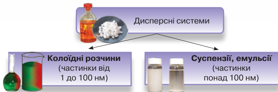
Схема 10 Класифікація дисперсних систем за розміром частинок дисперсної фази
