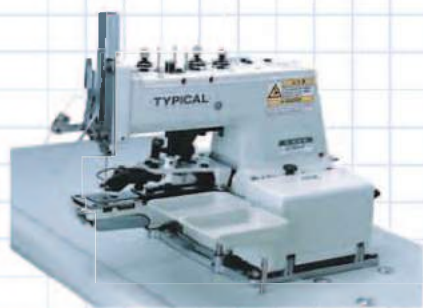
Швейна машина для пришивання гудзиків
